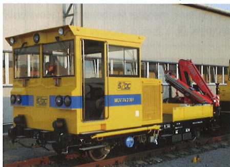
První vyrobená drezína MUV 74/CZ LOKO z limitované série s pořadovým číslem 001, osazena hydraulickým pohonem firmy Chvalis
