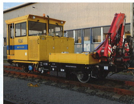
Drezína MUV 74/CZ LOKO může být osazena hydraulickou rukou nebo sněhovou radlicí
