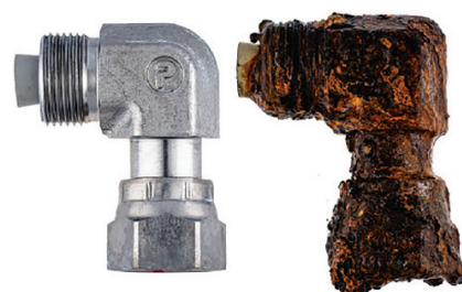
Otočný adaptér ToughShield Plus (vlevo) a otočný adaptér pokovený zinkem (vpravo) po 3000 hodinách testů SST
